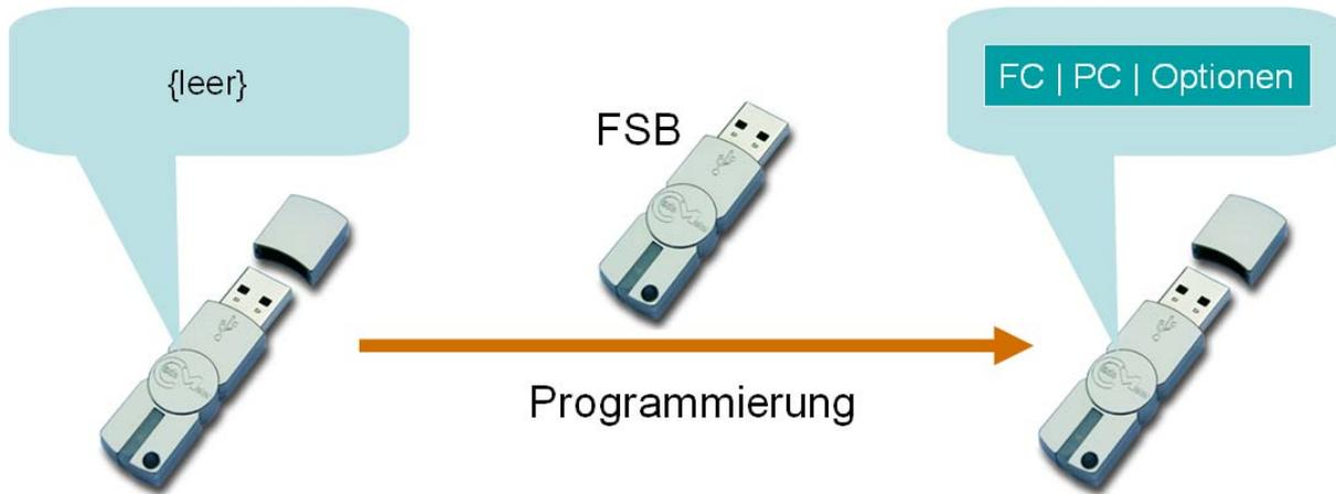
**Abbildung 3: Programmierung eines CmSticks**
